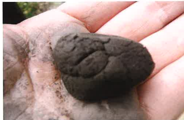
Fot. nr 130 Ściana południowa- odwiert geologiczny; podłoże gruntowe próba wałeczowania; widoczne cząstki ilaste
